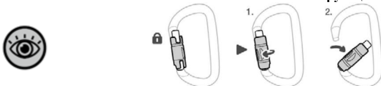
Рисунок 3. Открытие / закрытие / фиксация запорного элемента с самоблокирующимся механизмом.
