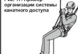
Рис. 17. Пример организации системы канатного доступа
