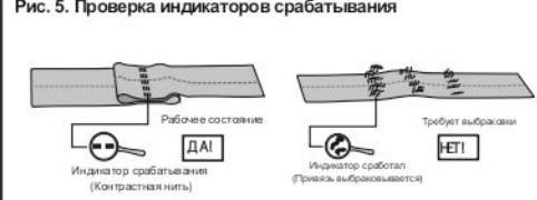
Рис. 5. Проверка индикаторов срабатывания
