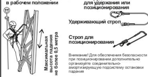
Рис. 17. Пример организации системы канатного доступа
