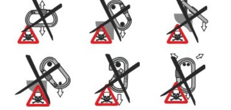
Рис. 4. Опасные способы использования карабинов
